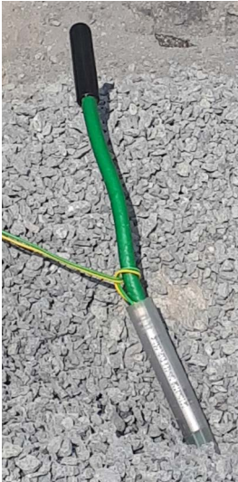
Abb. 26 Befestigung eines Zünders an der Sprengschnur
