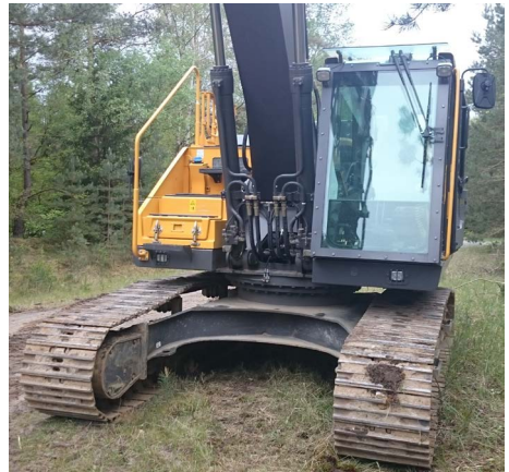
Abb. 34 Bagger mit Sicherheitssonderverglasung
