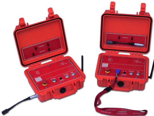
Abb. 22 Beispiel eines Zündgerätes für nicht-elektrische Zündanlagen
