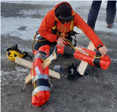
Abb. 46 Herstellen einer Wurfladung
