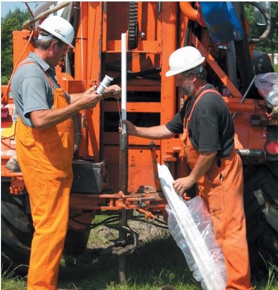
Abb. 38 Laden einer Sprengung für geophysikalische Zwecke
